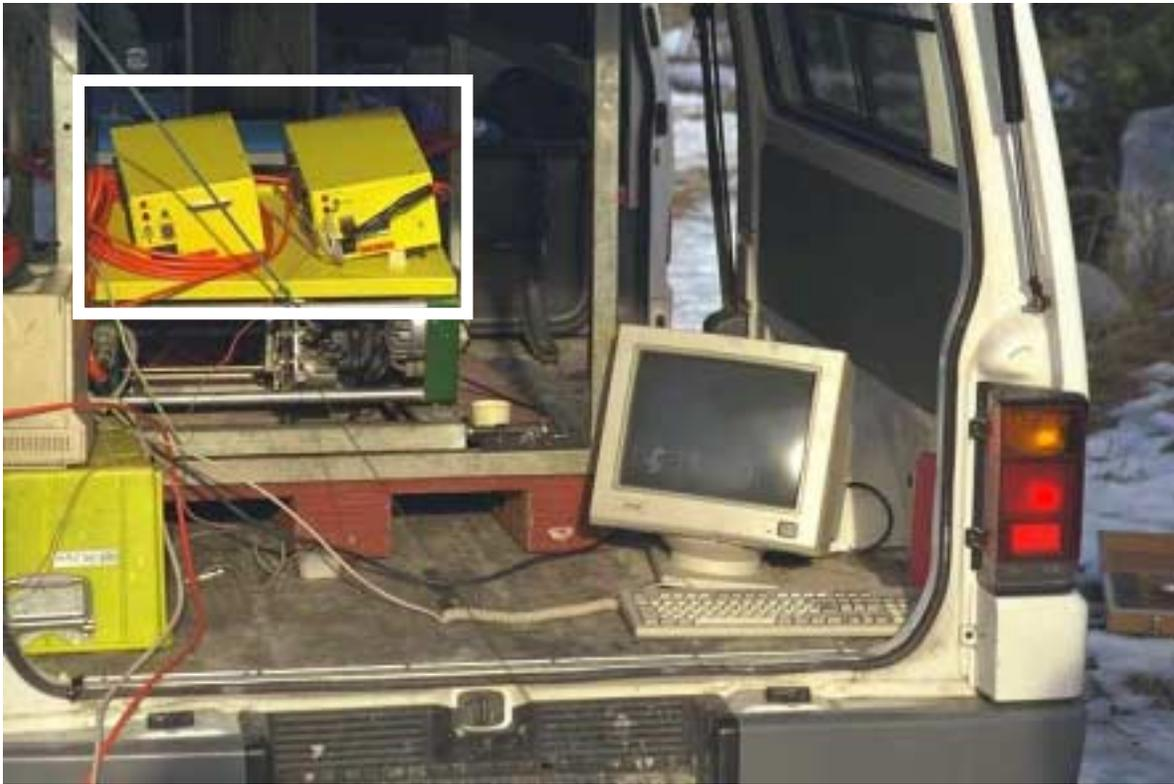
**Figure 1.6 : Boîtier de commande et de digitalisation de l'équipement Mount Sopris.**
