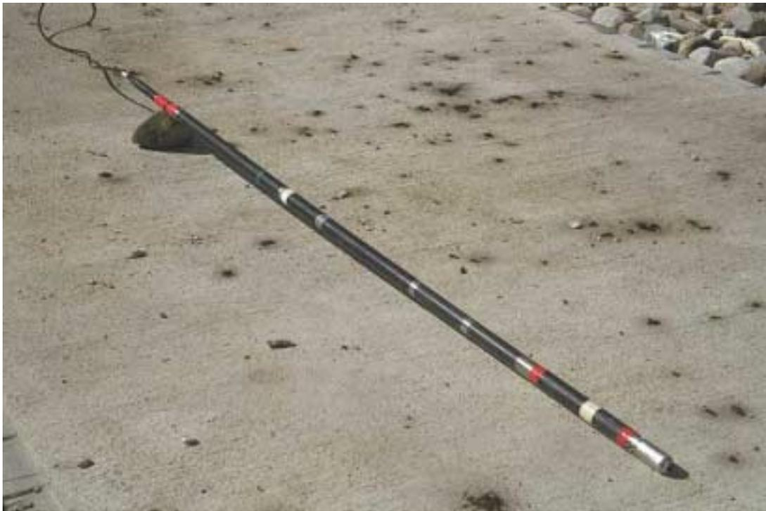
**Figure 1.7 : Sonde combinée (Normales, monoélectrode, polarisation spontanée, gamma ray, température, résistivité du fluide).**
